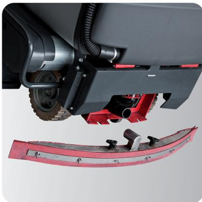
Conjunto de cepillos de acero inoxidable. Sistema innovador AIR RECUPERACIÓN (patentado), gracias al aire comprimido canalizado delante del cepillo: se evita la dispersión lateral de la solución del detergente.
