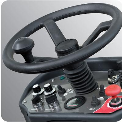
Panel de control con controles fáciles e intuitivos que incluyen: contador de horas, indicador de nivel de carga de la batería, luz de depósito vacío e indicador de marcha adelante/atrás. Regulación de velocidad, bocina, regulación de la presión del cepillo central, regulación
